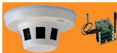
Obr. 9 Ilustrativní srovnání velikostí detektoru standardního a senzorického - na šířku a na výšku
